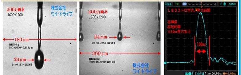
吐出体積を1%で計測する飛翔観測装置
